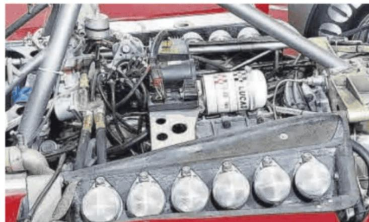
Motor 12 cilindros en V a 180°.
